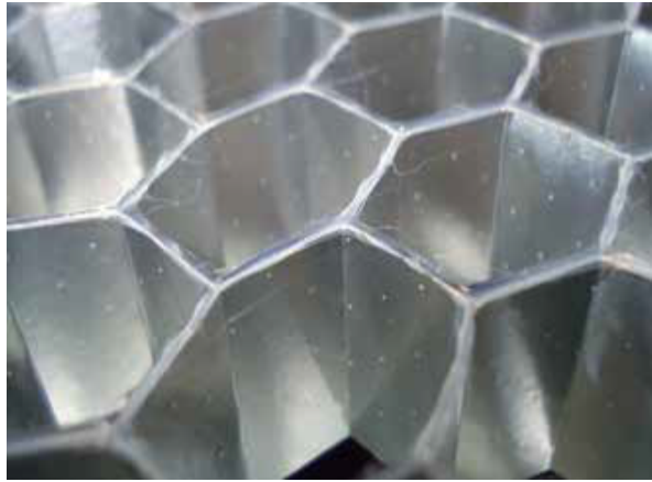
Panel de aluminio unido con capas de cubierta de aluminio con adhesivo KLEIBERIT 543.8 2C PUR
