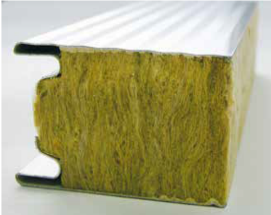
Lana mineral y capas de revestimiento de acero unidas con el PanelPUR A2 KLEIBERIT 983.2
